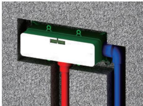
Вырежьте отверстие в стене, соответствующее размеру монтажной коробки.
