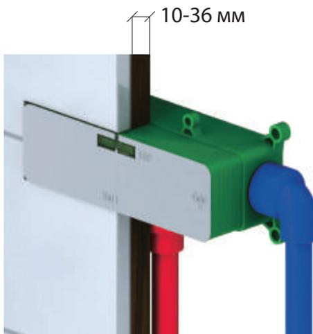
Вырежьте отверстие в полую стену, соответствующее размеру монтажной коробки, в желаемом месте установки смесителя.
